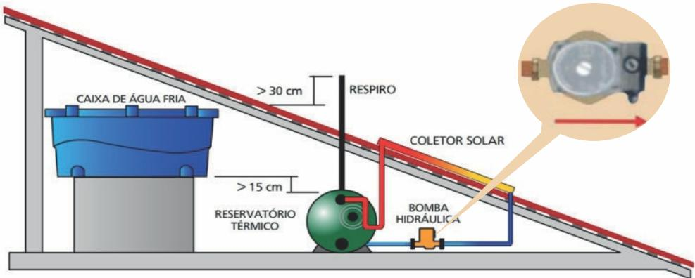
Esta bomba é ideal para sistema solar, onde existe a necessidade de circulação forçada. Mas também pode ser utilizada para simples circulação de água quente ou fria. Acima um desenho meramente ilustrativo com um exemplo de aplicação da **ECO100BR**.
