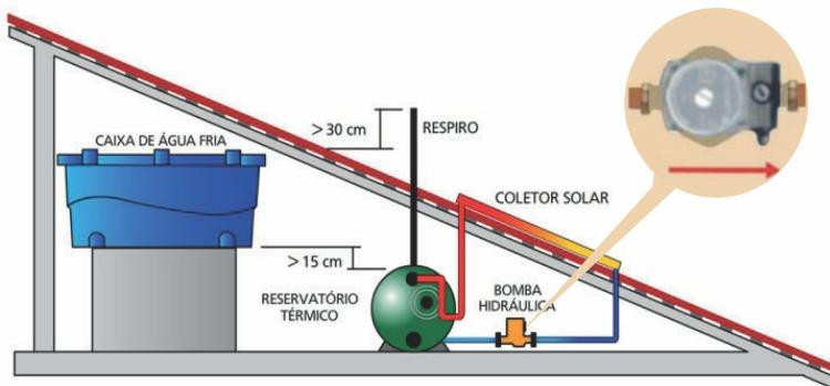
Esta bomba é ideal para sistema solar, onde existe a necessidade de circulação forçada. Mas também pode ser utilizada para simples circulação de água quente ou fria. Acima um desenho meramente ilustrativo com um exemplo de aplicação da **ECO248BR**.
