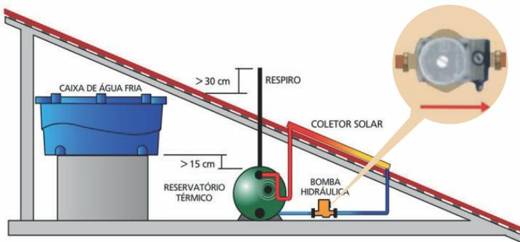
Esta bomba é ideal para sistema solar, onde existe a necessidade de circulação forçada. Mas também pode ser utilizada para simples circulação de água quente ou fria. Acima um desenho meramente ilustrativo com um exemplo de aplicação da **ECO350BR**.
