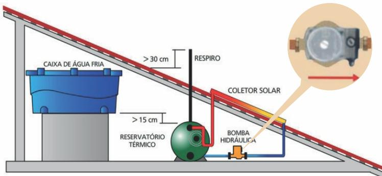
Esta bomba é ideal para sistema solar, onde existe a necessidade de circulação forçada. Mas também pode ser utilizada para simples circulação de água quente ou fria. Acima um desenho meramente ilustrativo com um exemplo de aplicação da **ECO550BR**.
